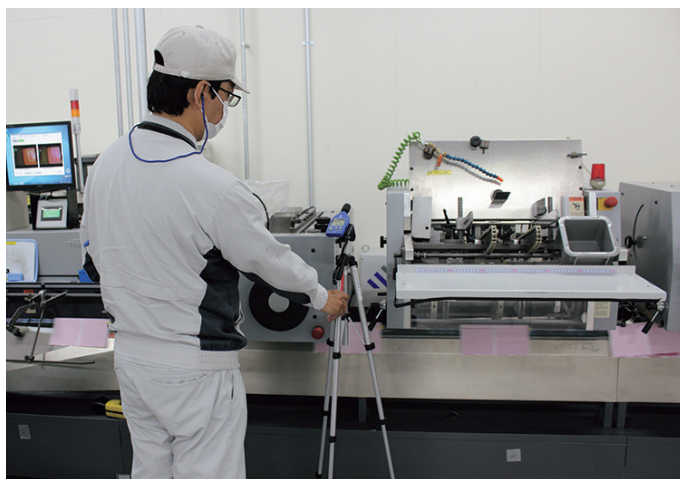
写真:B測定点(製本機)の騒音測定
