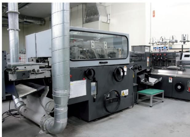
写真：製本機に設置されている局所排気装置
